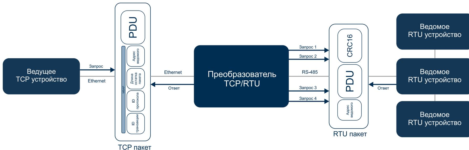
Блок-схема работы преобразователя в режиме «Сконфигурированных запросов»
